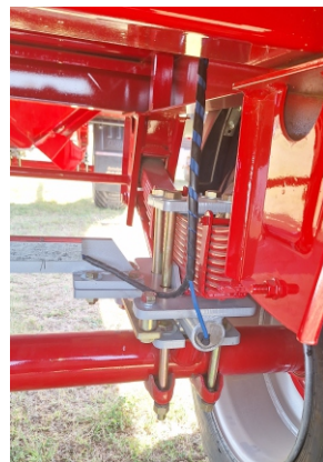
Eje delantero y suspensión. Opcional: Balanza.
