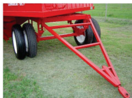
Lanza y tren del. con aro giratorio a bolilla de 870mm.
