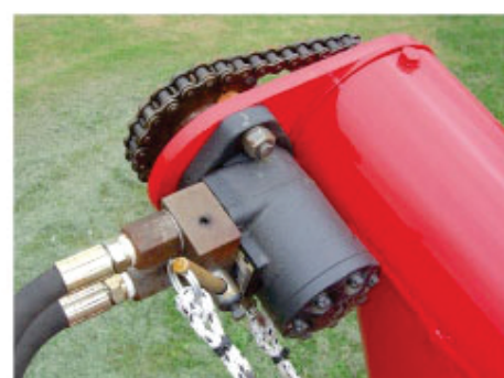
Motor hidráulico con multiplicador de velocidad.
