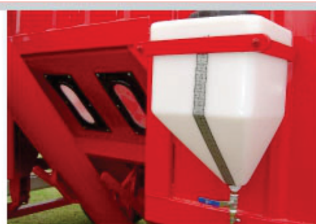
Depósito para inoculante y visores.
