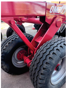
Sistema de trabas para transporte.
