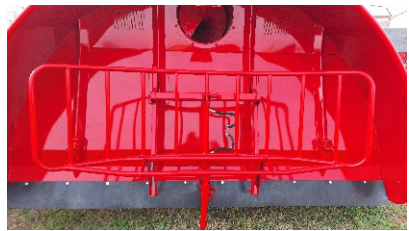
Sistema hidráulico para elevación de bolsa.
