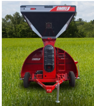
Máquina en posición de trabajo con patas de apoyo traseras para sacar el tractor.
