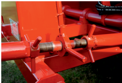
Chasis y lanza regulables, articulados.
