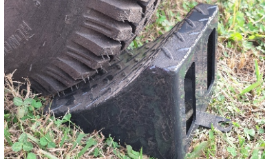
Cuña para frenado de la máquina en reposo.
