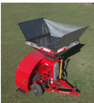
Máquina en posición de trabajo con patas de apoyo traseras para sacar el tractor.
