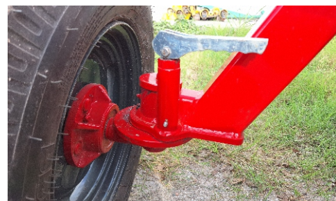
Sistema de traba de rueda para facilitar el paso de posición de transporte a trabajo y viceversa.
