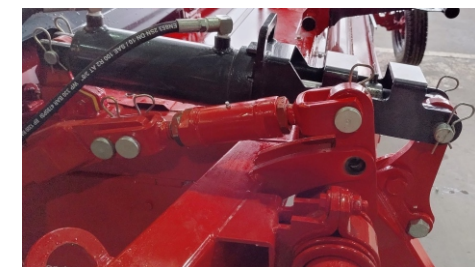
Sistema de traba para poder sacar el cilindro y registro de nivelación para inclinar la máquina.
