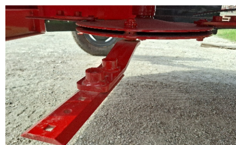
Sistema de cuchillas móviles con 4 filos.
