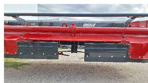
Pantalla móvil de regulación de hilerado.
