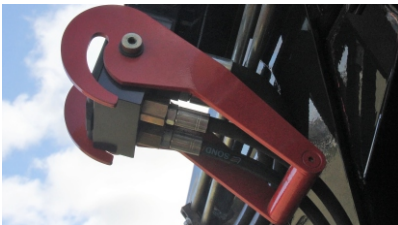
Acople hidráulico opcional dependiendo de la marca de la cosechadora.
