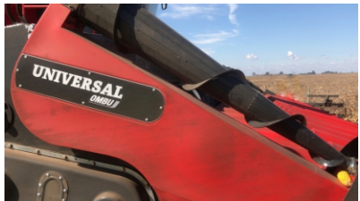
Rolos laterales superiores para encauce de plantas de serie con transmisión hidráulica y velocidad regulable desde la cosechadora.
