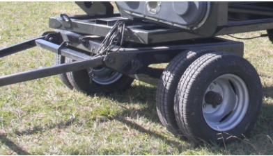
Carro con avant tren del largo del cabezal y lanza rebatible ocupando un mínimo espacio en galpón o carretón. 14 surcos 2 ejes, 16-18-20 surcos 3 ejes.
