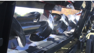
Embocadores cambiables totalmente abulonados, para uso con cualquier tipo de cosechadora.
