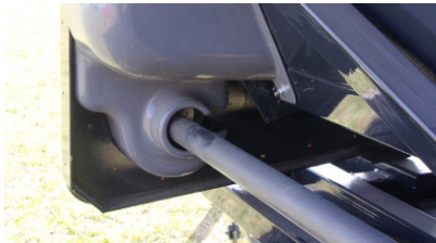
Mando de sinfin independiente del mando de cajas con 2 velocidades disponibles.
