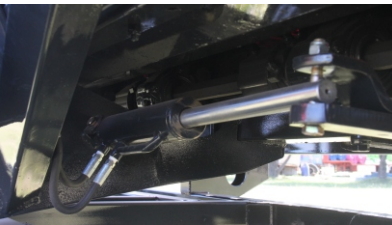
Movimiento de chapas cubre rolo móviles hidráulico de serie regulables desde la cosechadora.
