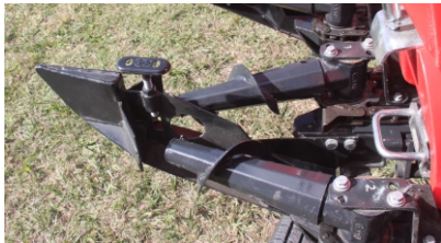
Cuerpos recolectores con rolos entregadores con velocidad mayor a las cadenas alzadoras.
