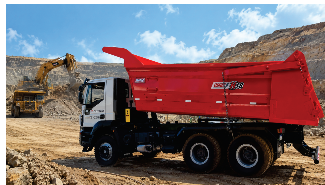
Puerta trasera de apertura simple y cierre automático.
