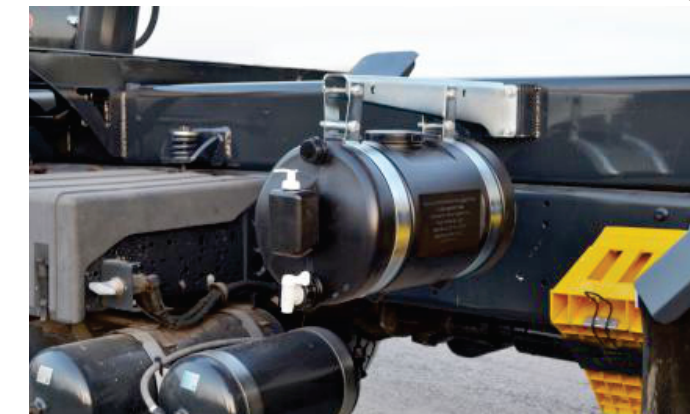
Tanque de agua.
